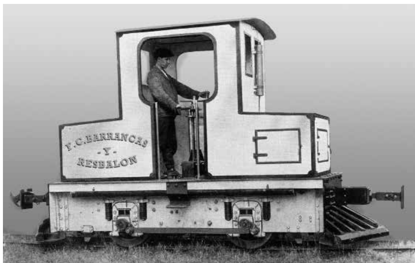
La primera locomotora diesel de Chile fue adquirida por el ferrocarril de Resbalón a Barrancas en 1911. Fabricada por McEwan, Pratt & Co., contaba con transmisión por bielas y la suspensión por resorte, desapareció a fines de la década del 20.
