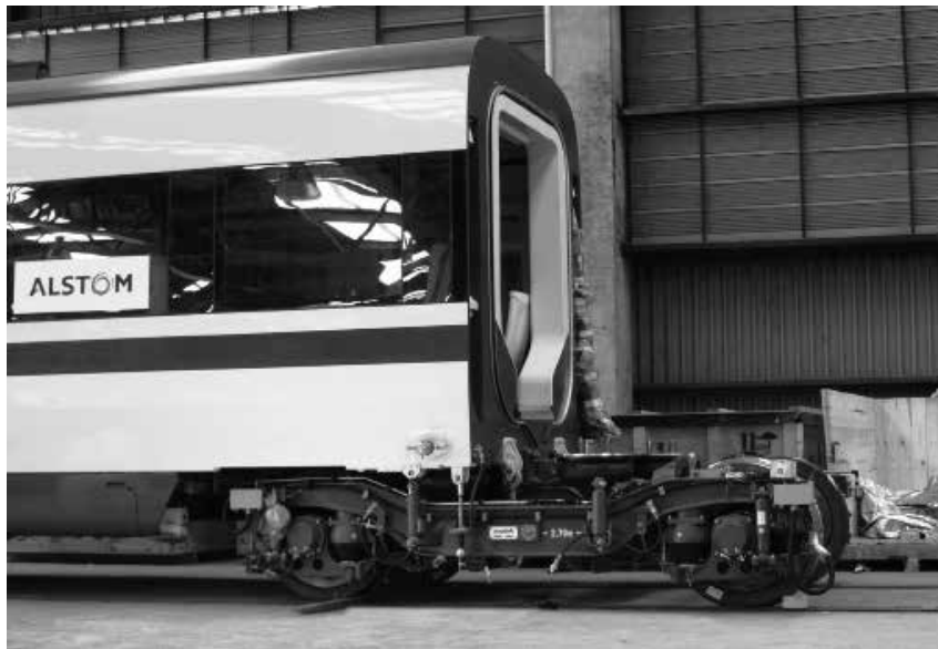
Armado del primer tren, mostrando el bogie común. Diciembre 2013. Foto Jorge Verdugo.
