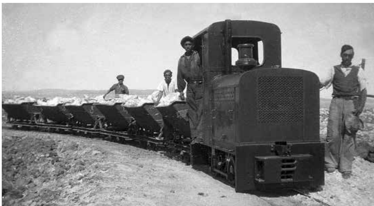
La pequeña locomotora Deutz adquirida por la minera Punta de Lobos para el transporte de sal entre la "Troya" y el inicio del andarivel a la caleta de Rio Seco se detiene un instante a mediados de 1950, mientras remolca seis vagones volquete con "colpas" de sal gema.
